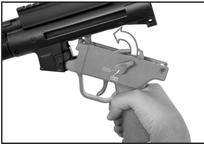
Fig. 50 – Insert pistol grip
